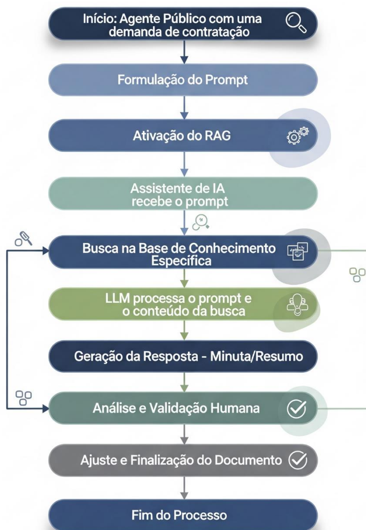
Figura 1 – Fluxograma do Processo de Interação e Validação do Protótipo de IA Generativa. (Fonte: Elaborado pelo autor, 2025).
