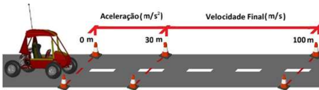
Figura 1: Representação dos testes de aceleração e velocidade.
