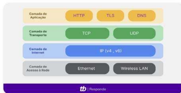
Figura 5: Camadas do modelo TCP/IP
