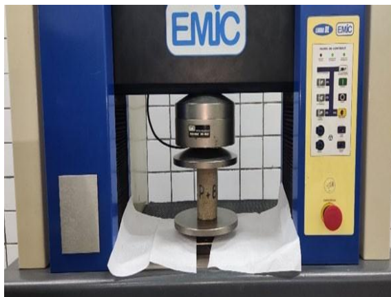
Figura 2: Ensaio de Resistência à Compressão Simples
