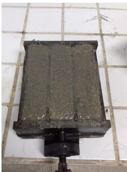
Figura 16 – Moldagem dos corpos de prova.
