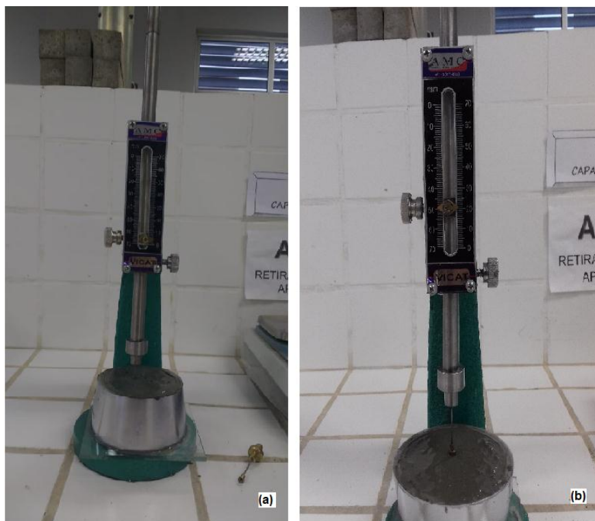
Figura 10 – Ensaio de pega: (a) momento da determinação do início de pega; (b) penetrações após o início de pega com o molde já invertido.
