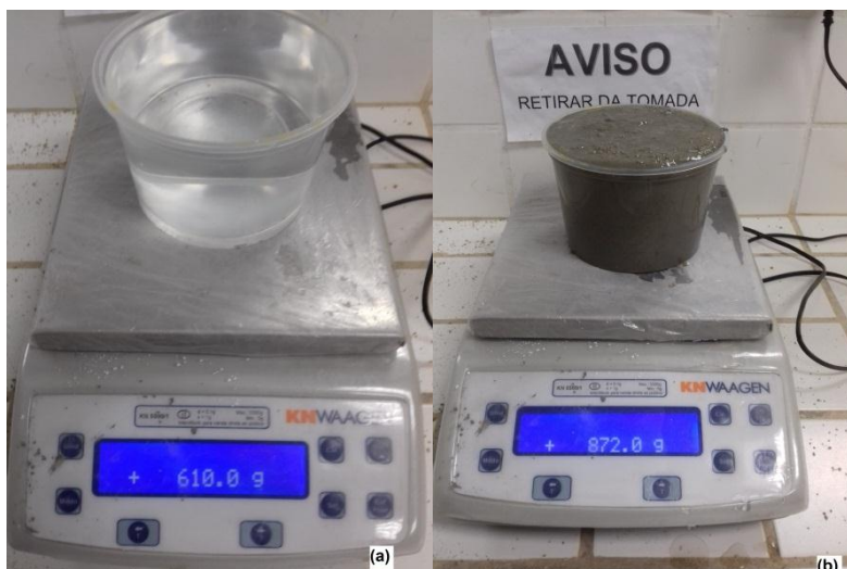
Figura 15 – Ensaio de densidade no estado fresco: (a) aferição do recipiente com água; (b) recipiente preenchido com argamassa.
