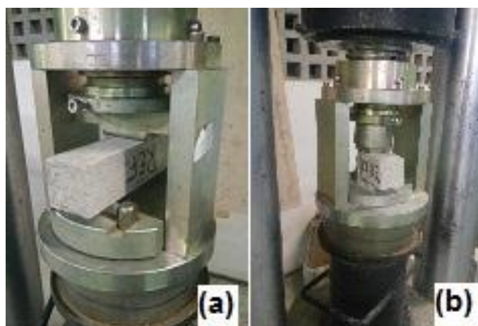
Figura 18 – Ensaios mecânicos: (a) tração na flexão; (b) compressão.
