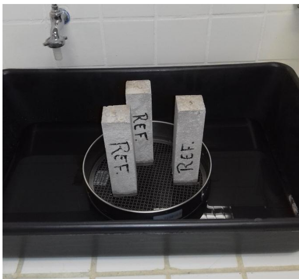
Figura 17 – Ensaio de absorção por capilaridade.
