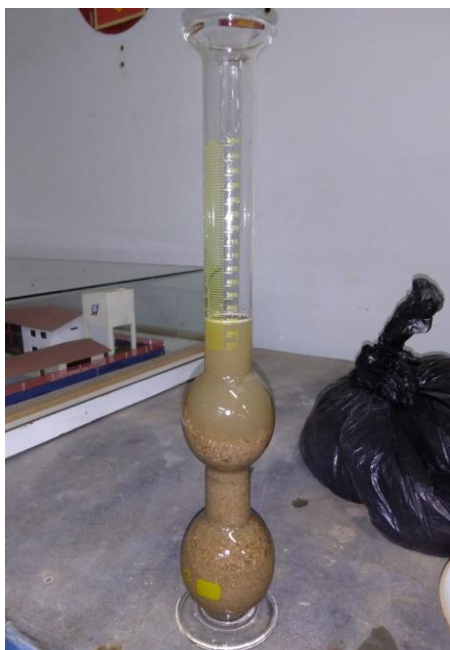
Figura 12 – Ensaio de massa específica pelo frasco de Chapman
