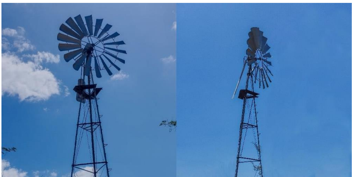
Figura 1 – Cata-vento para bombear de água
