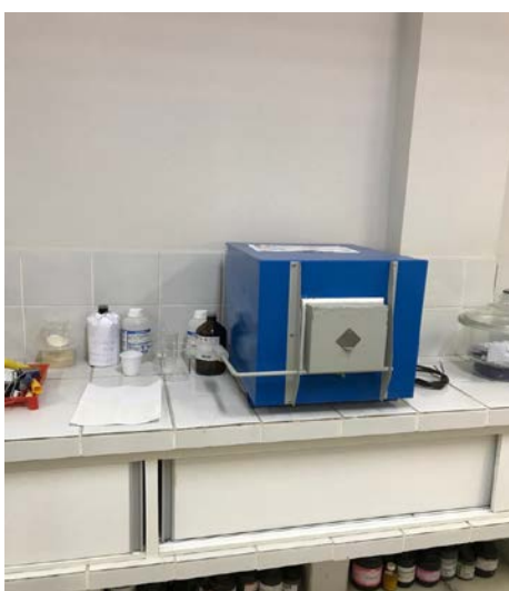
4.c) Forno Mufla em local inadequado
