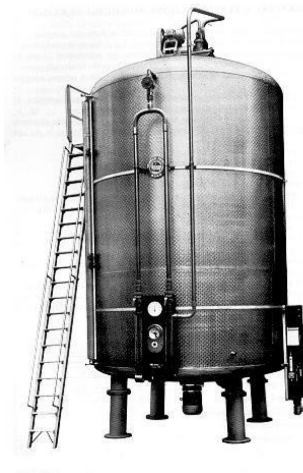
Figura 3. Vista geral de um acetificador em aço inoxidável.
