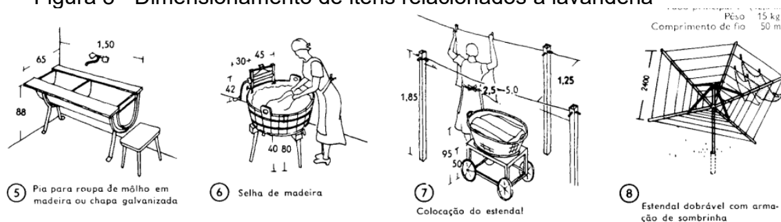
Figura 8 - Dimensionamento de itens relacionados à lavanderia
