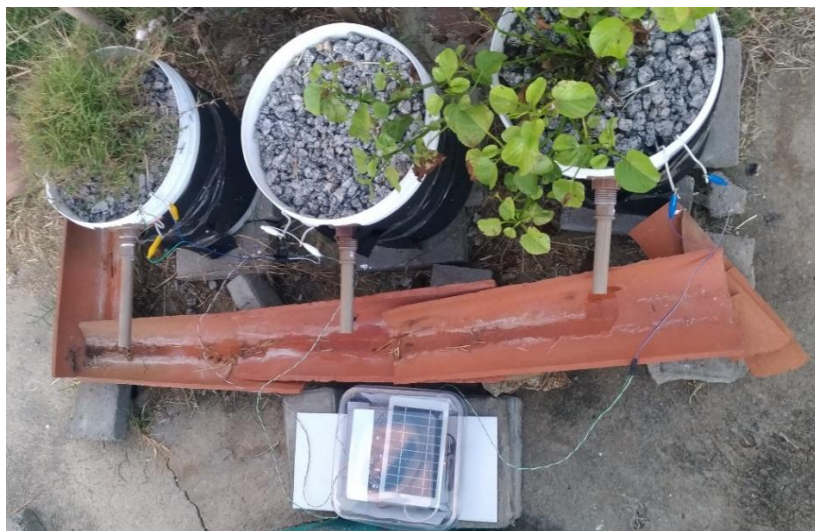
Figura 7 - Sistema de monitoramento embarcado realizando medições nos biorreatores.
