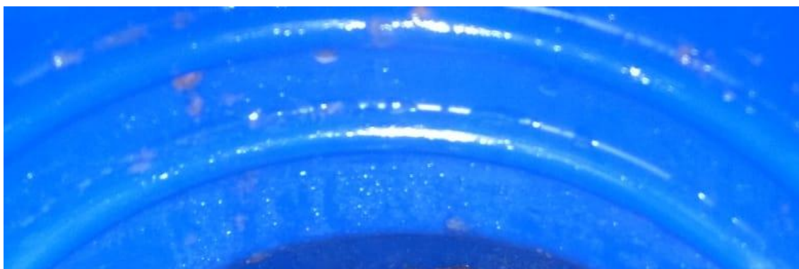
Figura 19: Fluidos condensados da reação nas paredes da cuba
