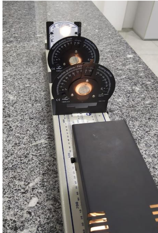
Figura 6 – Feixe de luz incidindo em polaroides com mesma angulação
