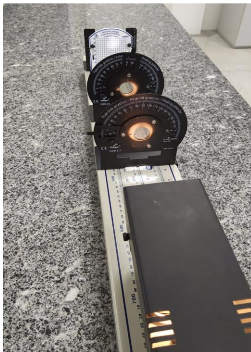
Figura 7 – Feixe de luz incidindo em polaroides com diferentes angulações
