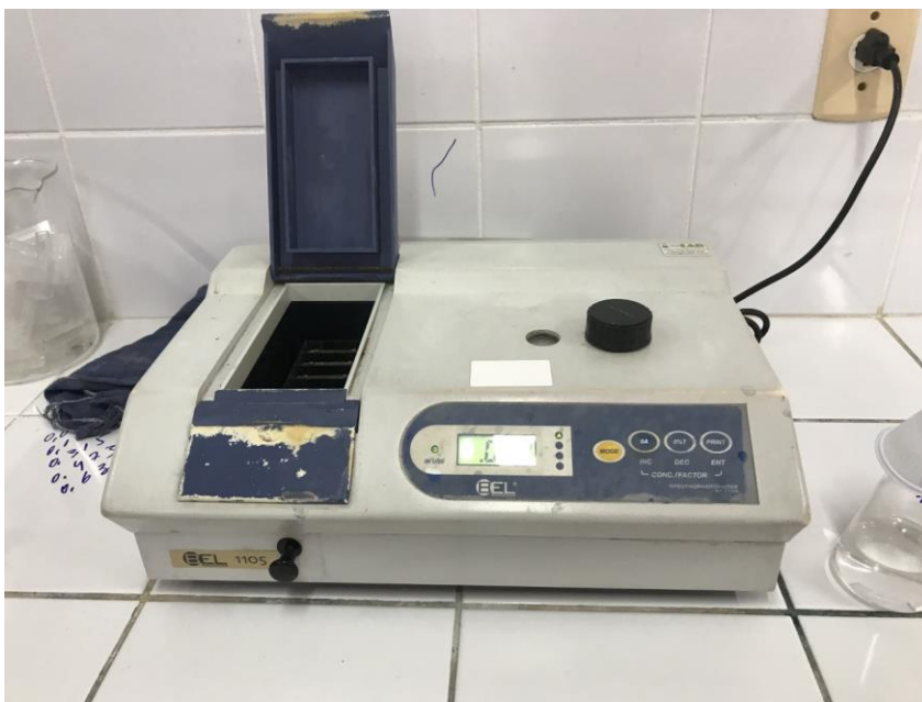
Figura 4 – Espectrofotômetro digital utilizado para identificar os teores de fósforo do solo, presente no LASAP - UFERSA.
