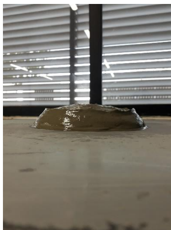
Figura 6: Pasta do CP IV-40 com a/c = 0,50 após a retirada do molde com 75 min (Autora Própria, 2021).
