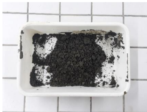
Figura 10: Pasta Cimentícia Relação água/cimento 0,25 CP V-ARI (Autora Própria, 2021).
