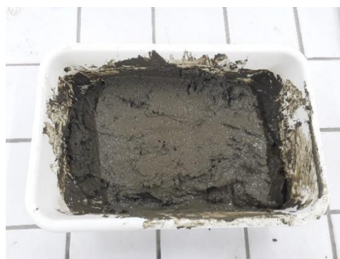
Figura 4: Pasta Cimentícia Relação água/cimento 0,35 CP IV-40 (Autora Própria, 2021).
