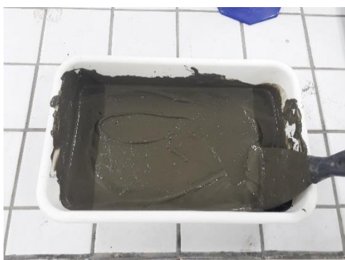
Figura 3: Pasta Cimentícia Relação água/cimento 0,45 CPV-ARI (Autora própria, 2021).
