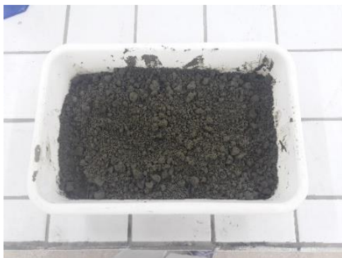
Figura 9: Pasta Cimentícia Relação água/cimento 0,25 CP IV-40 (Autora Própria, 2021).
