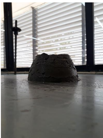
Figura 5: Pasta do CP II-E-40 com a/c = 0,30 após a retirada do molde com 75 min (Autora Própria, 2021).
