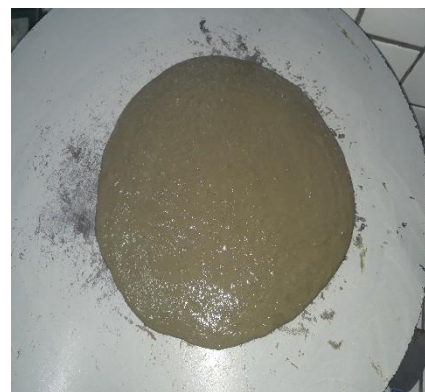
Figura 7: Pasta do CP V-ARI pronta para a medição de espalhamento com a/c = 0,35 após 15 min (Autora Própria, 2021).
