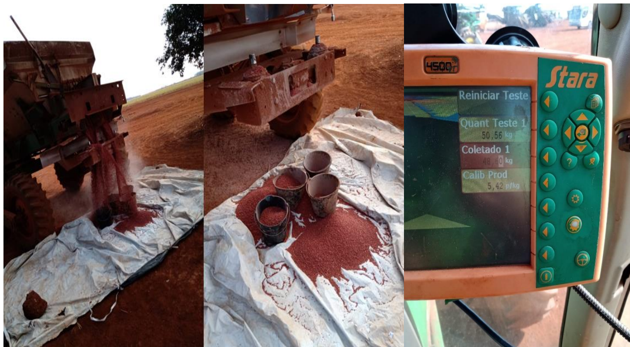
Figura 9. Aferição da calcareadeira para a aplicação de KCl.
