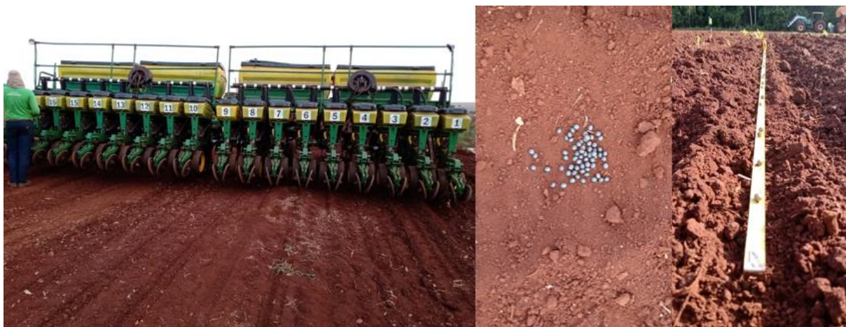
Figura 18. Aferição do número de sementes depositados por metro e distribuição na linha.
