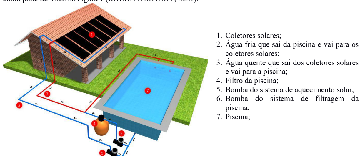
Figura 1. Sistema de Aquecimento Solar para Piscinas. Fonte: Soletrol (Aquecedores Solares para Piscinas, 2025)
