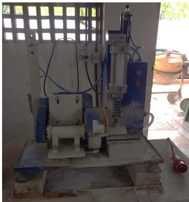
Figura 7 – Aparelho de retificação dos corpos de prova
