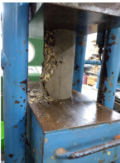
Figura 9 – Prensa hidráulica manual utilizada
