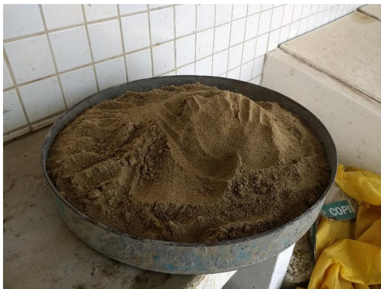
Figura 3 – Secagem da areia até atingir a umidade higroscópica
