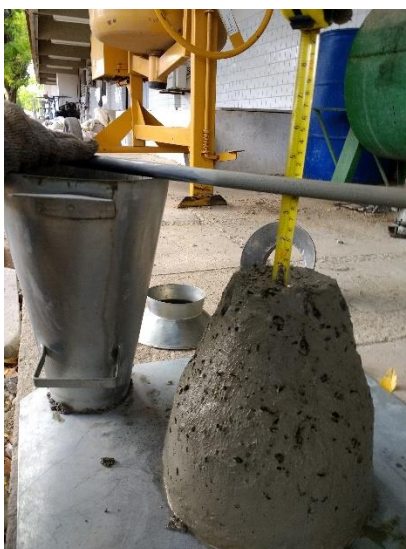
Figura 5 – Ensaio de abatimento do tronco de cone
