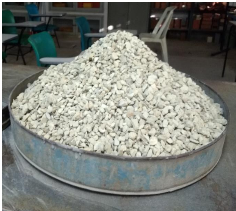
Figura 2 – Secagem do material até atingir a umidade higroscópica
