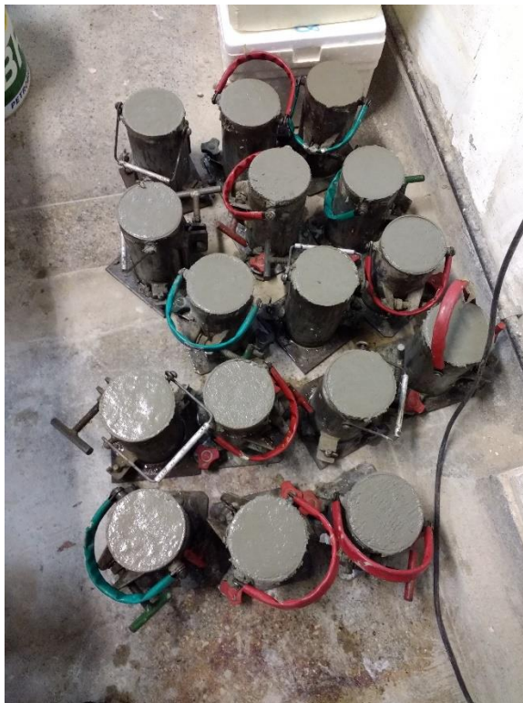
Figura 6 – Corpos de prova alocados em superfície plana
