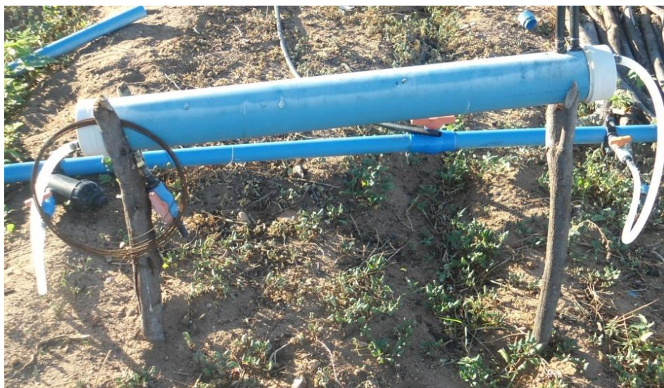
Figura 2 - Tanque de derivação de fluxo de PVC (“pulmão”). Mossoró-RN, UFERSA, 2013.
