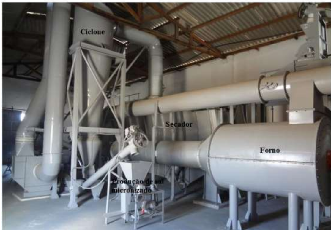
Figura 2: Secador de leito fluidizado no setor de refinaria.
