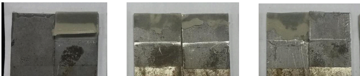
Figura 4.5 – Superfícies de falhas com espessura de 0,4 mm.
