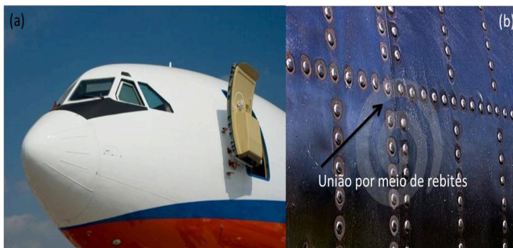
Figura 2.14 - Avião mais moderno, onde sua união é feita por meio de adesivos (a) Avião com estrutura unida por meio de rebites (b). Fonte: Adesivos estruturais na construção de aviões.
