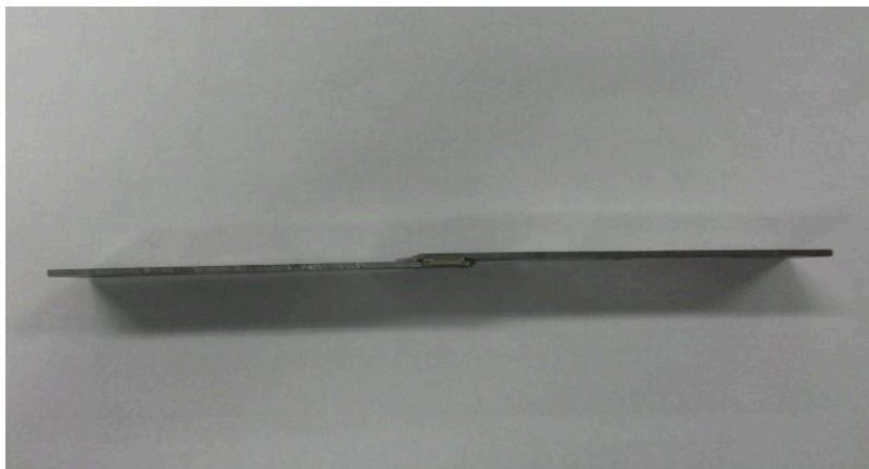
Figura 4.2 – Vista superior de uma das juntas de espessura 0,4 mm.
