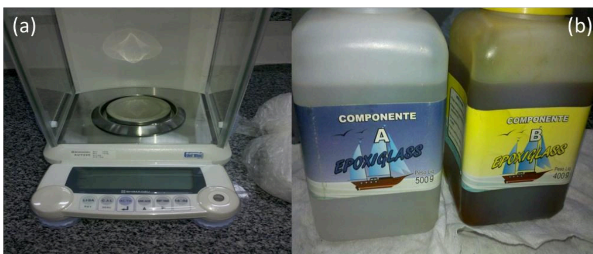
Figura 3.5 – Balança de precisão (a) e endurecedor e resina (b).
