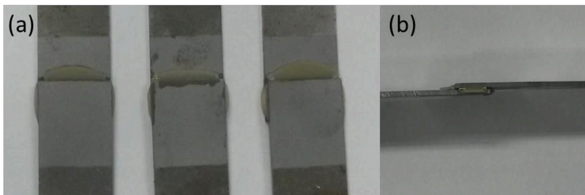
Figura 3.8 – Vistas do excesso da camada adesiva, vista frontal (a) e superior (b).
