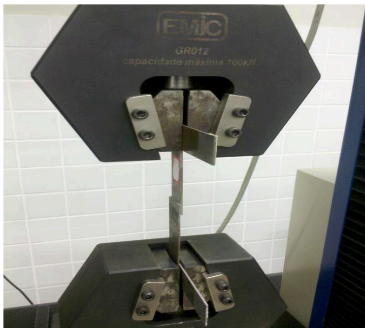
Figura 3.10 – Garras da máquina segurando o corpo de prova.
