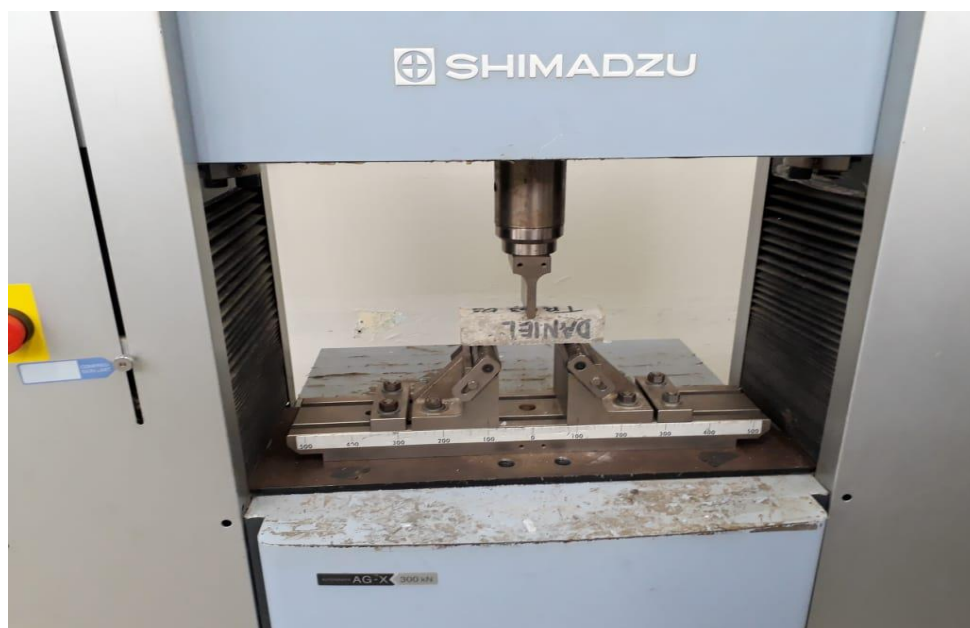
Figura 16: Ensaio de tração na flexão
