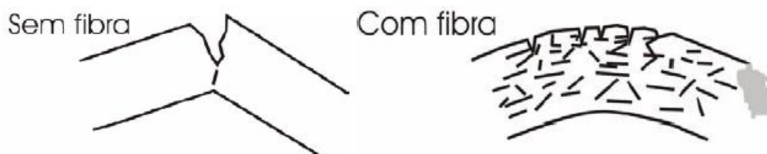
Figura 4: Ruptura de material com e sem adição de fibra
