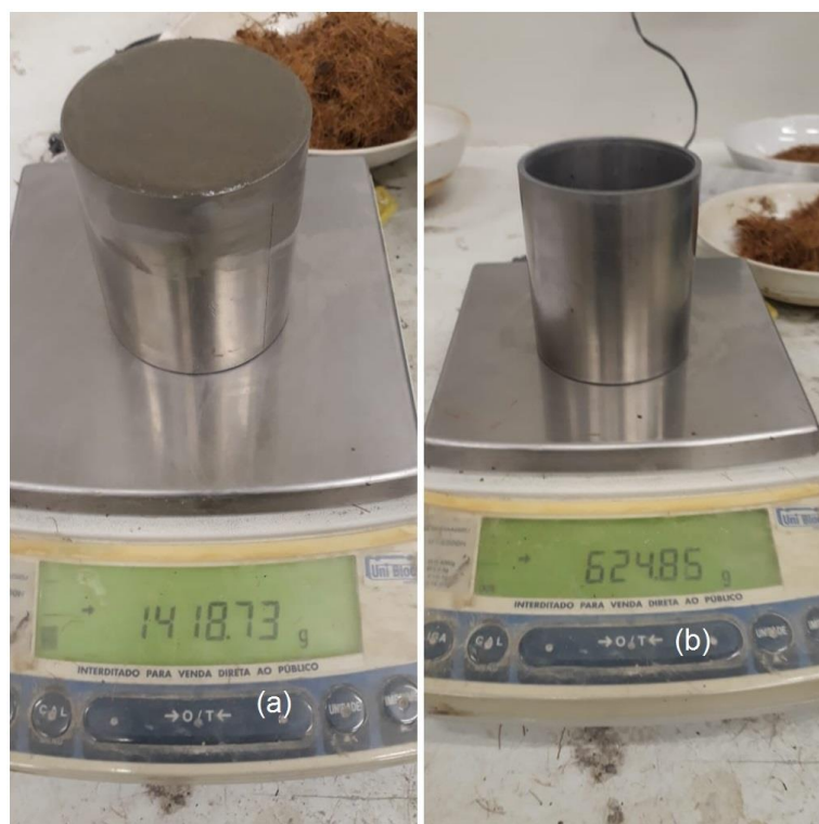
Figura 12: Densidade no estado fresco - (a) Recipiente cilíndrico contendo argamassa; (b) - Recipiente cilíndrico
