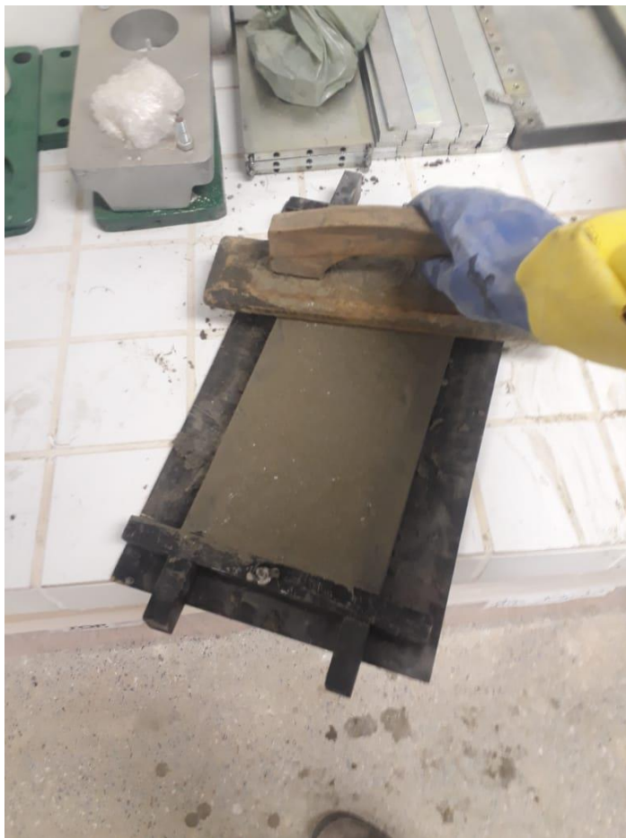
Figura 19: Confeção placas cimentícias
