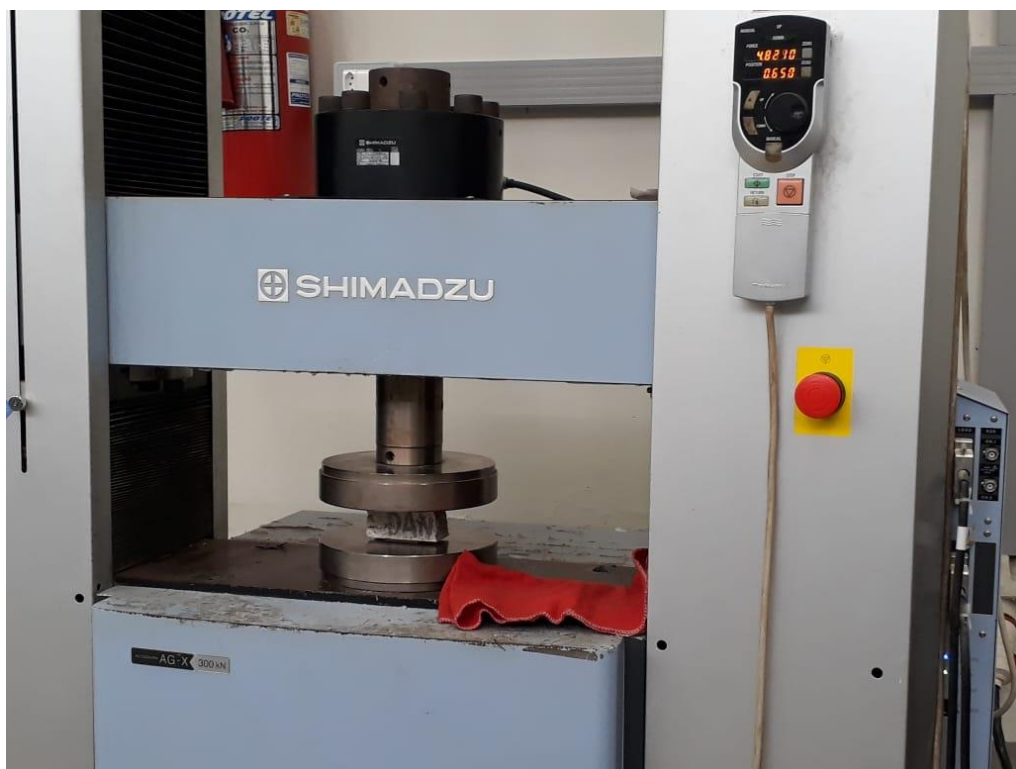
Figura 17: Ensaio de resistência à compressão
