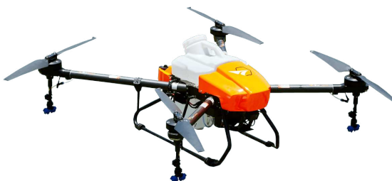
Figura 2.6. VANT Pelicano usado para pulverização.
