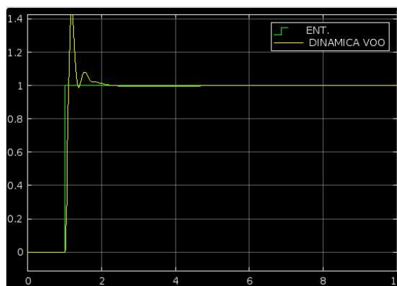
Figura 4.12. Resposta simulada com controle para o movimento de rolagem.
