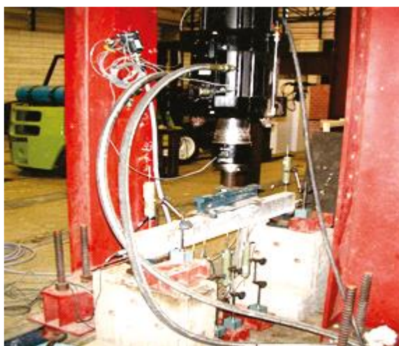
Figura 9: Prensa Hidráulica com capacidade de 500kN (FILHO et. al. , 2011).
