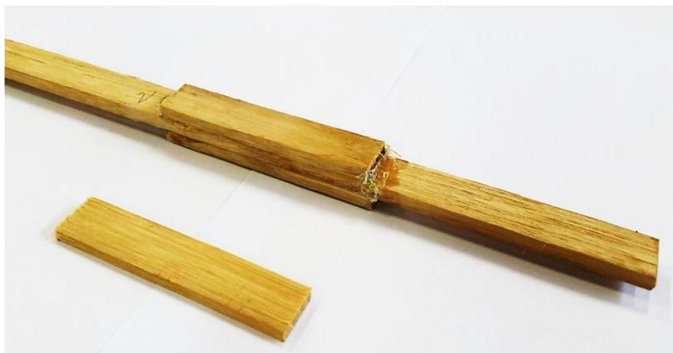
Figura 23: Detalhe da talisca com o nó reforçado e pedaço de bambu a ser aderido na região do nó (TSUTSUMOTO, 2016).
