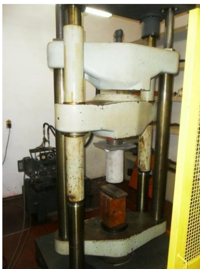
Figura 27: Ensaio de arrancamento (TSUTSUMOTO, 2016).
