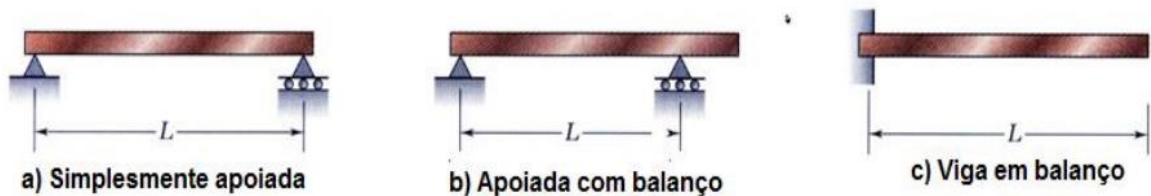
Figura 5 : Apoios de vigas isostáticas (HIBBELER, 2011).
