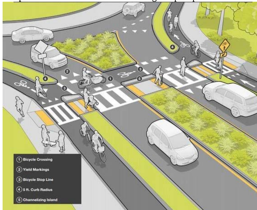
Figura 21: Exemplo ilustrativo e real de travessias seguras para pedestres.
