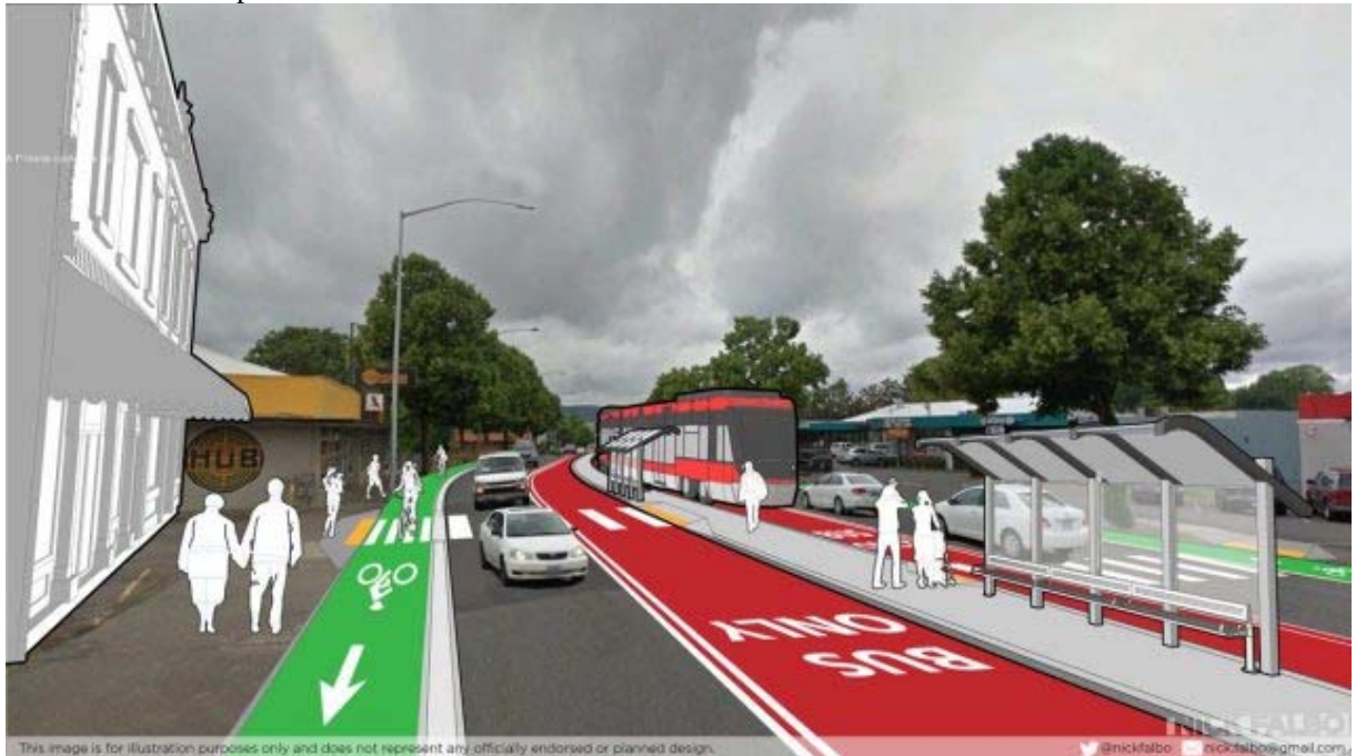
Figura 22: Exemplo ilustrativo de reorganização segura das faixas de uma via com implementação de faixas exclusivas para ônibus e ciclovias.
