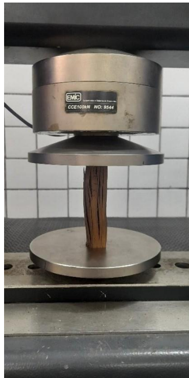
Figura 5: Corpo de prova sendo submetido no teste de compressão paralela às fibras realizado na máquina de ensaios EMIC.
