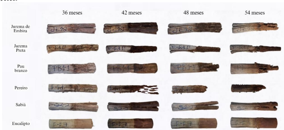
Figura 9: Representação evolutiva da deterioração dos corpos de prova em escala visual de cada uma das espécies.
