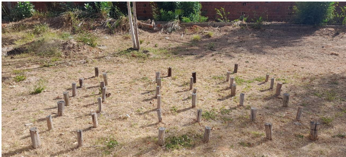
Figura 4: Campo de apodrecimento para madeiras de diferentes espécies florestais nativas da região Semiárida e amostras controle ( Eucalyptus tratado).
