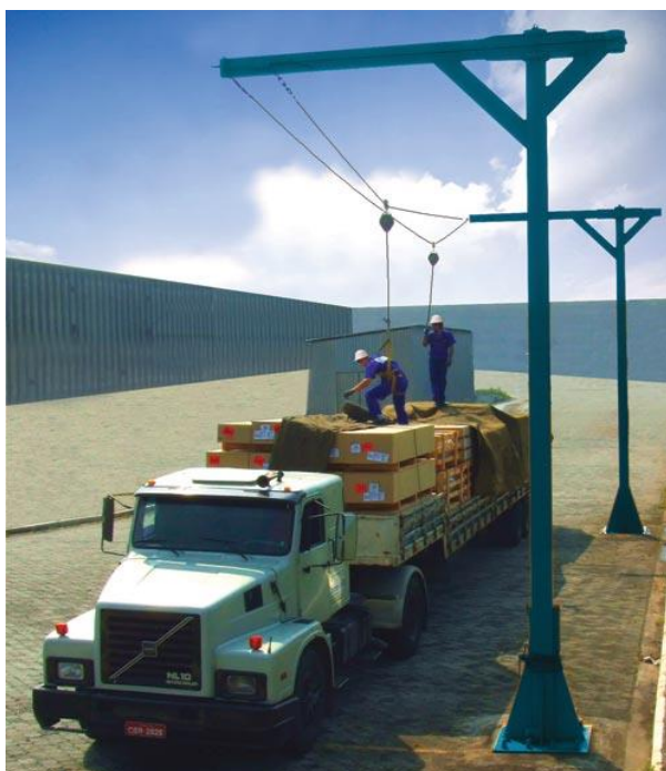
Figura 24: Exemplos de modelos de linhas de vida para acesso a carroceria de caminhões
