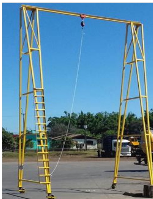
Figura 24: Exemplos de modelos de linhas de vida para acesso a carroceria de caminhões
