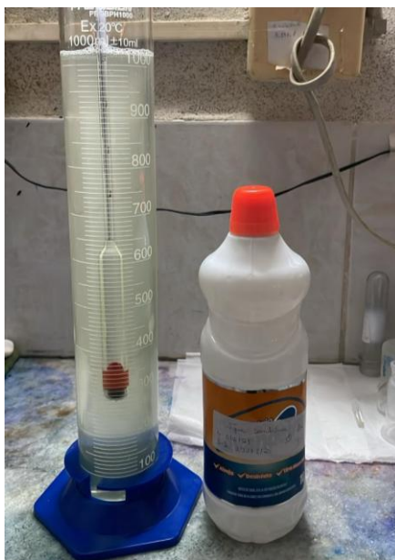
Figura 7. Determinação do teor de cloro da água sanitária.
