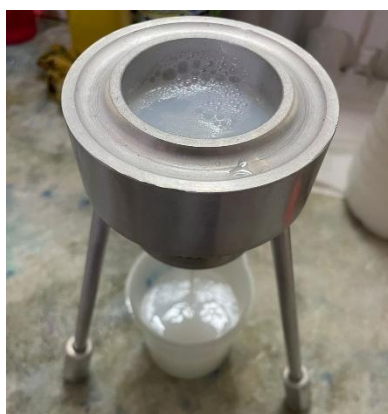
Figura 5. Viscosímetro de orifício.
