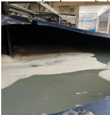
Figura 2. Produção de lava roupas líquido com agitação mecânica.
