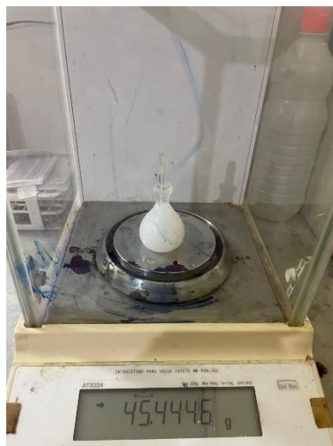
Figura 6. Método da picnometria.
