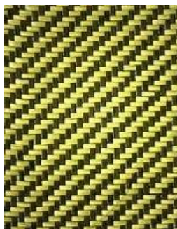
Figura 11 – Reforço utilizado no laminado proposto: tecido híbrido sarja 2x2
