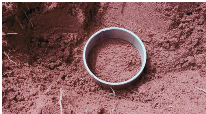
Figura 7 – Coleta de solo de amostras indeformadas
