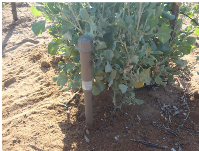
Figura 5. Detalhe do tensiômetro instalado em campo para determinação da umidade atual do solo.
