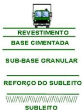
Figura 3: Camadas de um pavimento semirrígido
