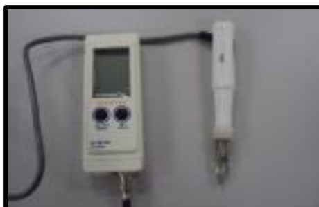
Figura 4 -Potenciômetro digital acoplado a um eletrodo de penetração. Fonte: Autoria própria.
