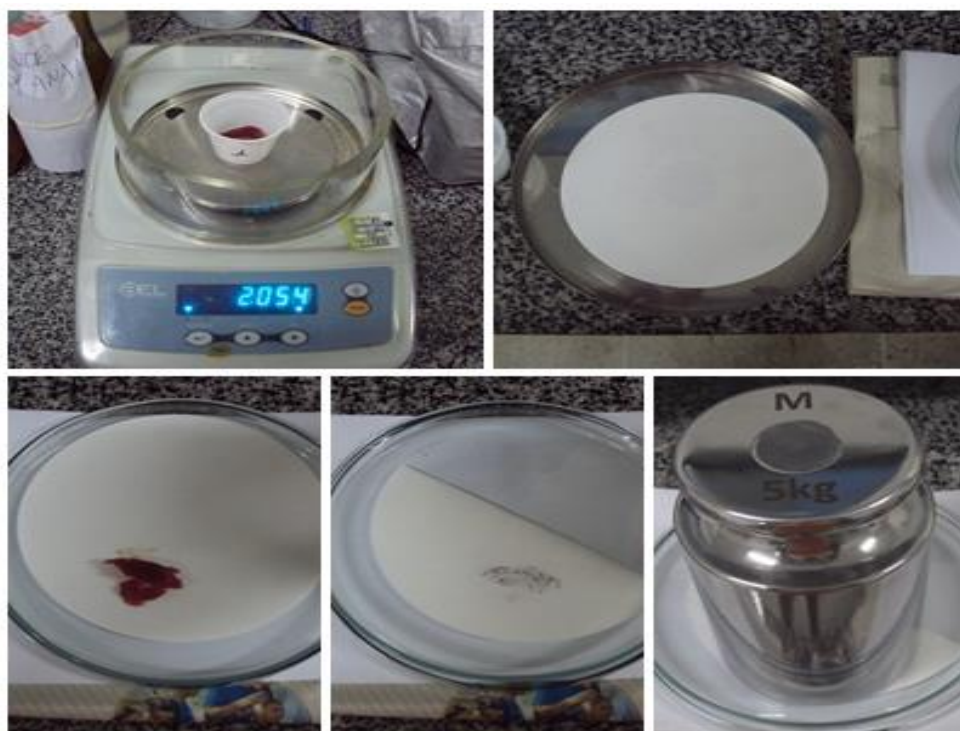
Figura 5 -Procedimento para obtenção da capacidade de retenção de água.
