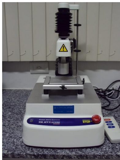
Figura 6- Texturômetro utilizado para identificar a força de cisalhamento das amostras de atuns.
