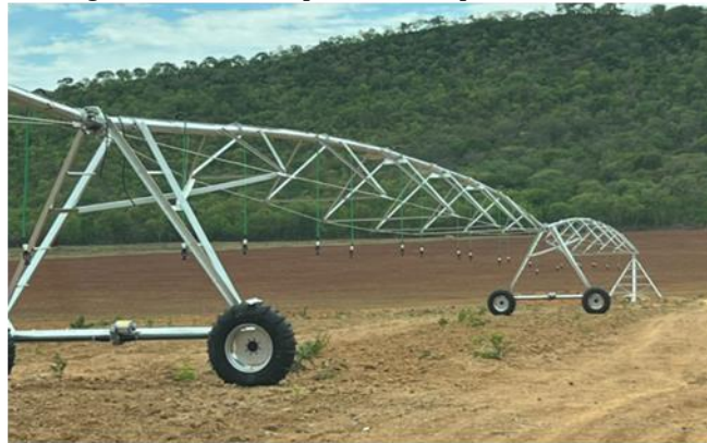
Figura 6- Lances do pivô central apoiados em torres.
