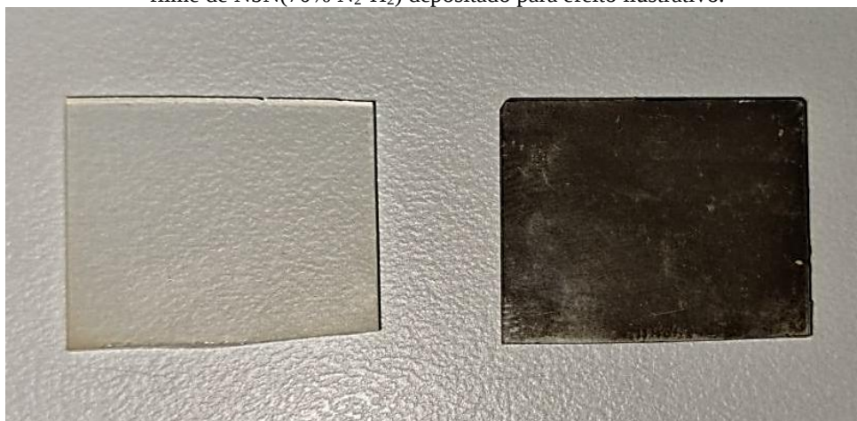
Figura 20 - Aspecto visual das lâminas de vidro Microscope Slides (20x25x1,5 mm), sem tratamento e com filme de NbN(70% N 2 -H 2 ) depositado para efeito ilustrativo.
