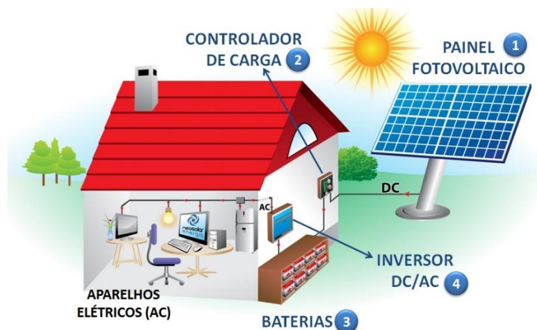
Figura 06: Demonstração da utilização do sistema isolado (Off-grid) de placas fotovoltaicas em residência
