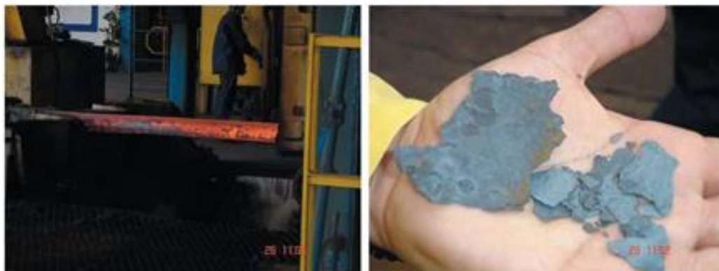
Figura 5 - Carepas na superfície do tarugo de aço (esquerda) e carepas eliminadas pelo processo a direita.
