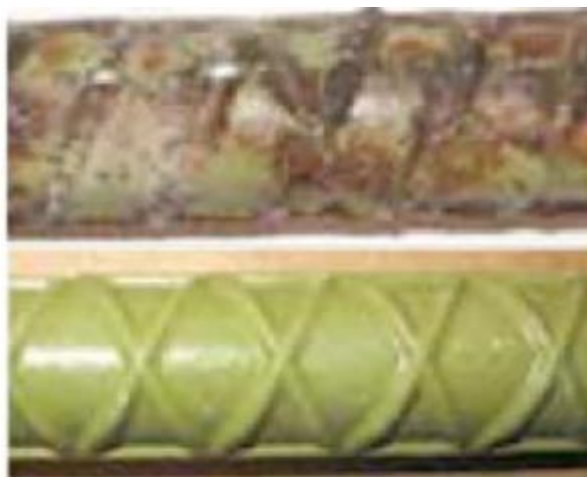
Figura 16 - Armaduras com pintura epóxi, com e sem corrosão.
