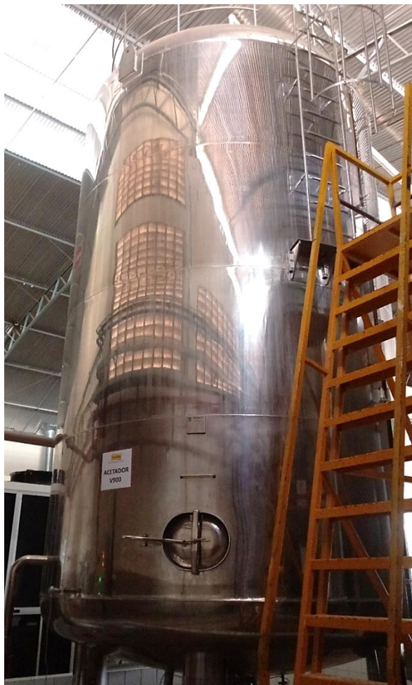
Figura 2. Acetador Frings utilizado na produção de vinagre
