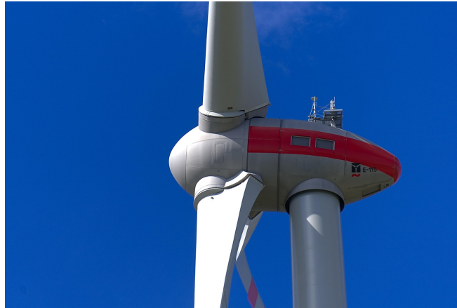
Figura 1: Detalhe frontal de um aerogerador horizontal, destacando o rotor, responsável pela captação da energia cinética dos ventos e conversão em energia mecânica.
