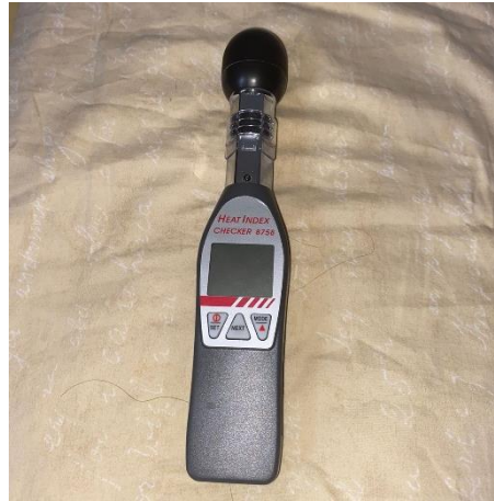
Figura 3 - Medidor de stress térmico/termômetro de globo WBGT8758, utilizado na coleta de temperaturas.
