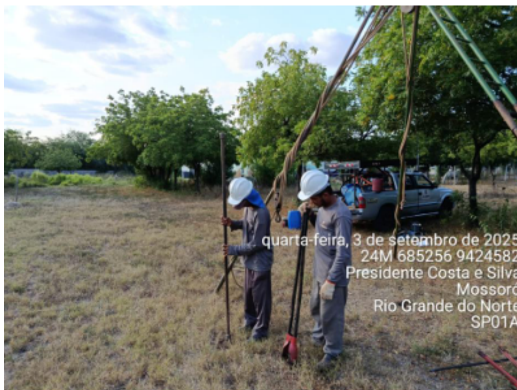
Figura 33 - Ensaio de sondagem no solo
