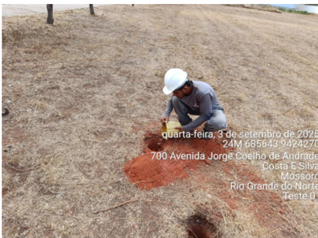
Figura 32 - Ensaio de percolação do solo
