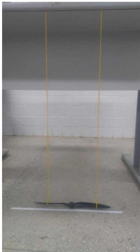
Figura 18 – Ensaio de um pêndulo de torção
