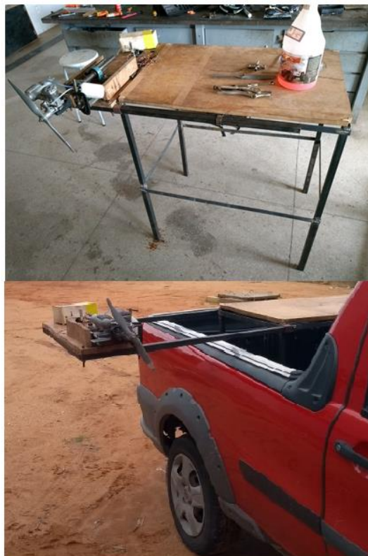
Figura 11 – Bancada construída em solo na picape
