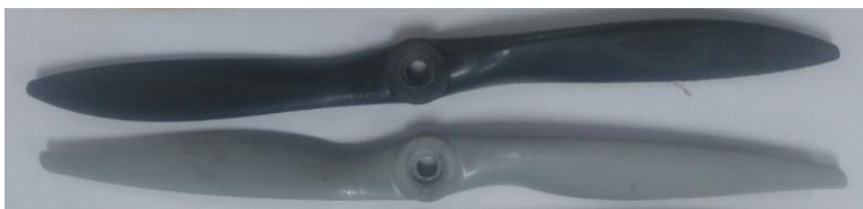
Figura 13 – Hélices APC 12x6 (cima) e APC 12x4 (baixo)
