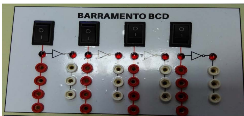
Figura 16 - Representação do barramento BCD no kit didático de Téofilo (2015).
