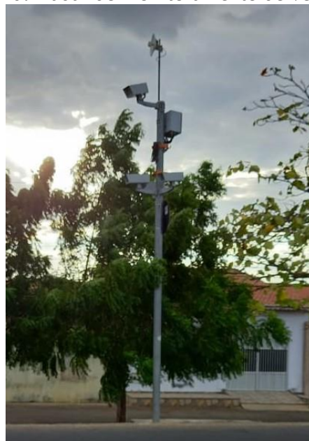
Figura 10: Radar de monitoramento de velocidade.
