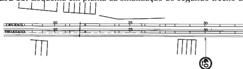
Figura 11: Esquema em planta da sinalização do segundo trecho da via.
