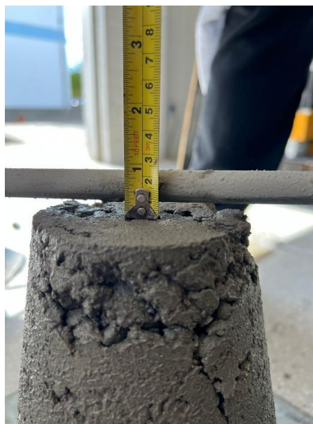
Figura 11: Teste de abatimento ou Slump Test
