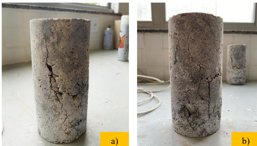
Figura 25: Corpos ensaiados em compressão axial. A) Ruptura cisalhada b) Ruptura coluna com formação de cones.
