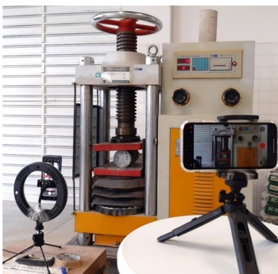
Figura 19: Esquema com posicionamento das câmeras
