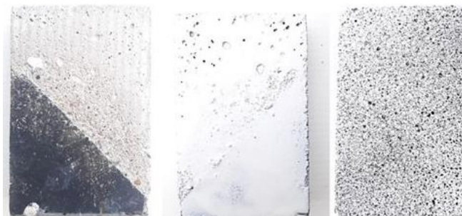
Figura 1: Preparação do padrão estocástico de uma argamassa assentada sobre um bloco de granito.
