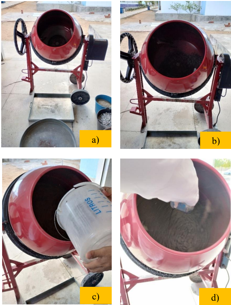
Figura 9: Adição dos materiais na betoneira
