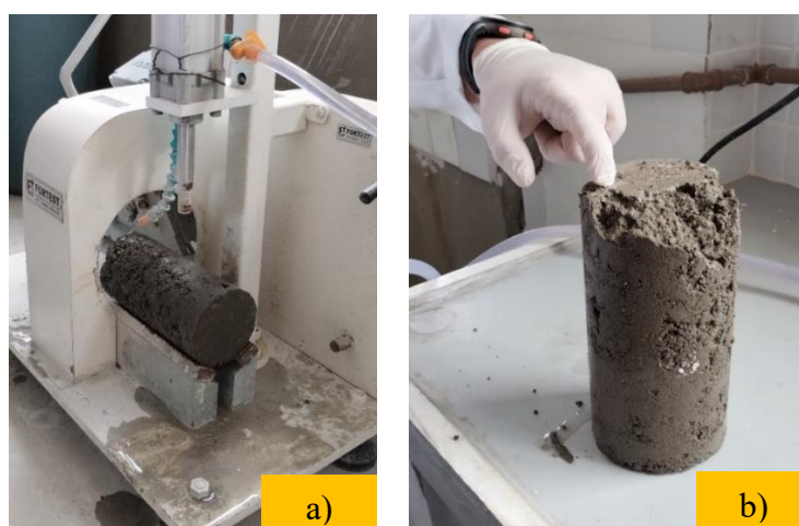
Figura 15: Processo de retificação dos corpos de prova
