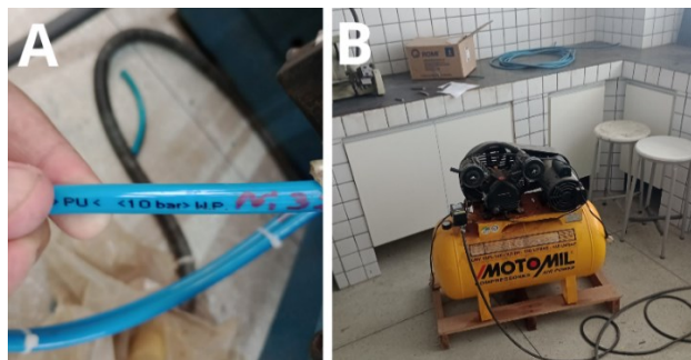
FIGURA 8. Componentes pressurizados encontrados no laboratório de usinagem da Ufersa: (A) Mangueira pneumática do torno CNC com indicação de pressão máxima de trabalho; (B) Compressor temporário do torno CNC. Fonte: Dados da pesquisa (2024).
