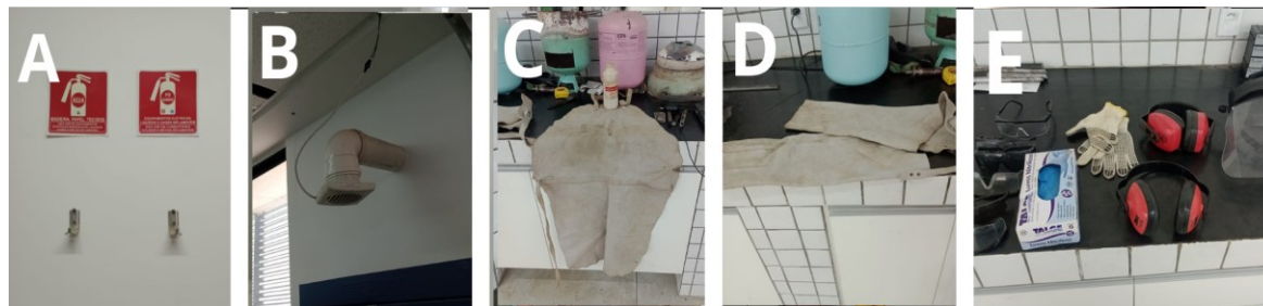
FIGURA 9. Riscos adicionais observados no laboratório de usinagem da Ufersa: (A) Ganchos de sustentação e sinalização dos extintores; (B) Micro ventilador; (C) Avental de couro; (D) Perneira de couro; (E) EPI's, tais como, óculos de proteção transparentes e escuros, luvas sintéticas e pigmentada, protetor auricular e máscara facial. Fonte: Dados da pesquisa (2024).
