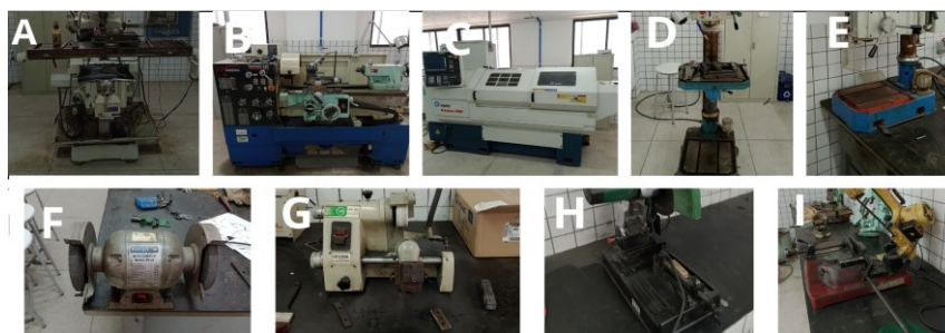
FIGURA 4. Arranjo físico e instalações do laboratório de usinagem da UFERSA: (A) Fresadora não demarcada; (B) Torno mecânico não demarcado; (C) Torno CNC não demarcado; (D) Furadeira de coluna não demarcada; (E) Furadeira de bancada não demarcada; (F) Esmeril não demarcado; (G) Afiadora não demarcada; (H) Serra policorte não demarcada; (I) Serra fita não demarcada. Fonte: Dados da pesquisa (2024).
