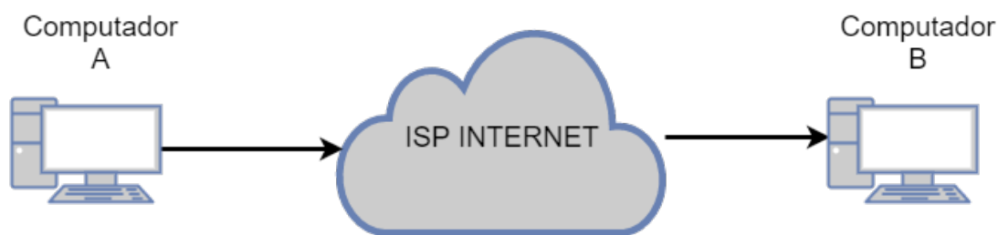
Figura 10: VPN do tipo Cliente-para-Cliente, onde nesse exemplo, dois computadores se comunicam por meio de um circuito físico simulado.
