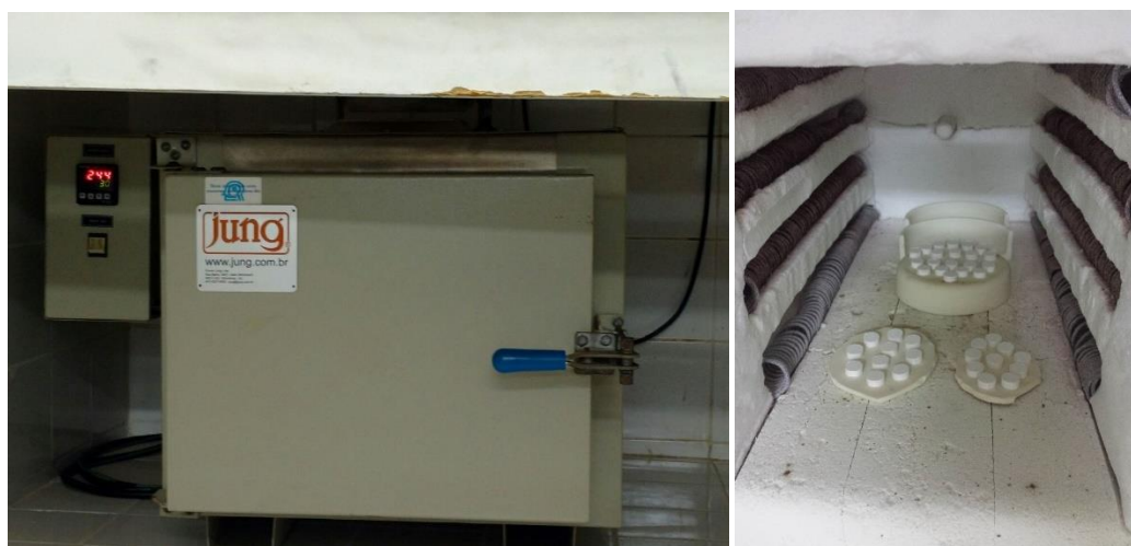
Figura 14: Forno utilizado na sinterização.
