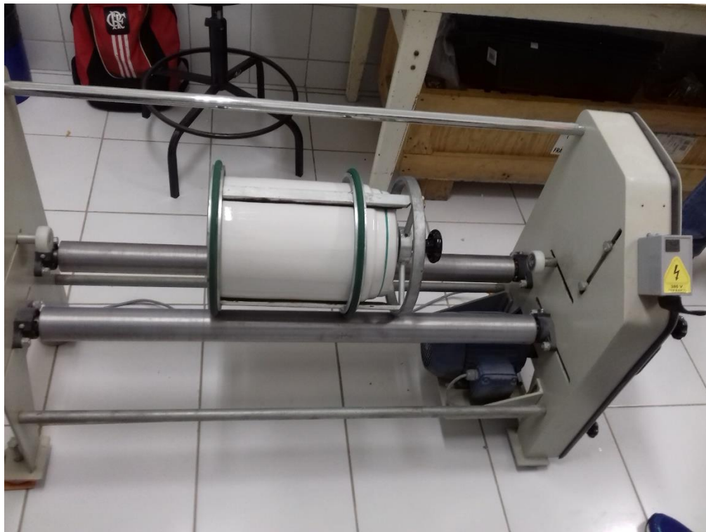
Figura 11: Misturador utilizado para misturar e homogeneizar as matérias primas.
