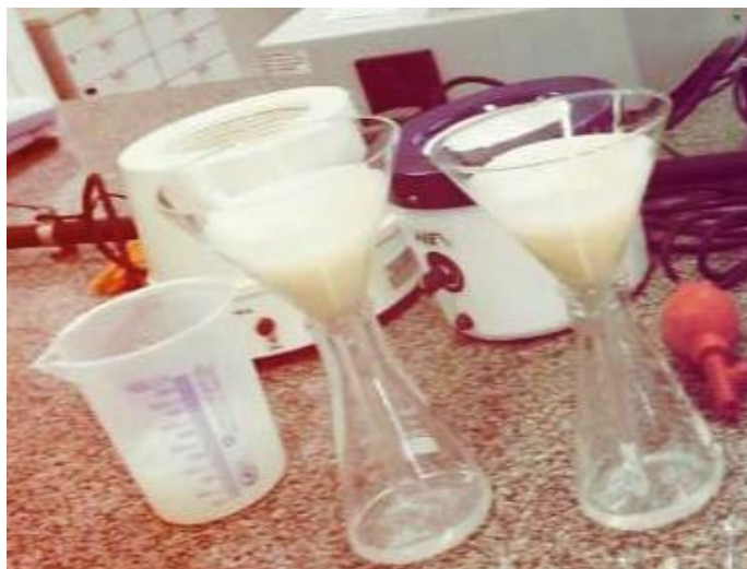
Figura 5 - Etapa pós-banho, filtração simples.
