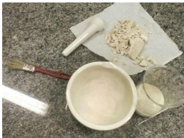
Figura 3 - Etapa de trituração dos calcários.
