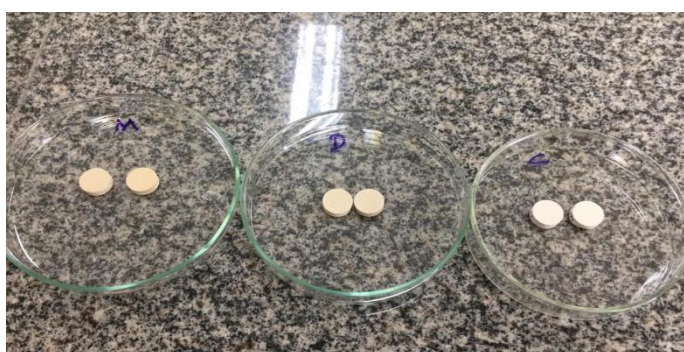
Figura 6 - Pastilhas confeccionadas com calcário.
