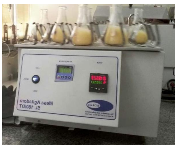
Figura 4 - (a) Procedimento de equilíbrio - 2h na mesa agitadora. (b) Repouso de 24h.
