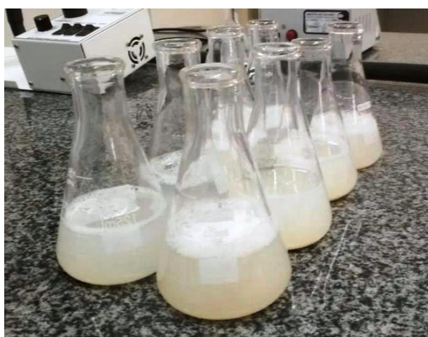
Figura 4 - (a) Procedimento de equilíbrio - 2h na mesa agitadora. (b) Repouso de 24h.
