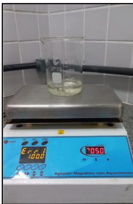
Figura 8 - Processo de dissolução da amostra de quitosana em solução de HCl.
