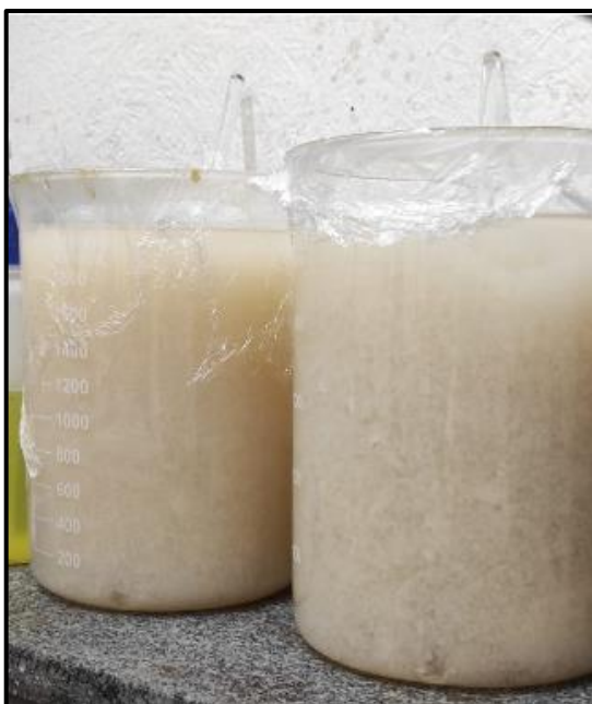
Figura 5 - Adição da solução de hidróxido de sódio e precipitação da quitosana purificada.
