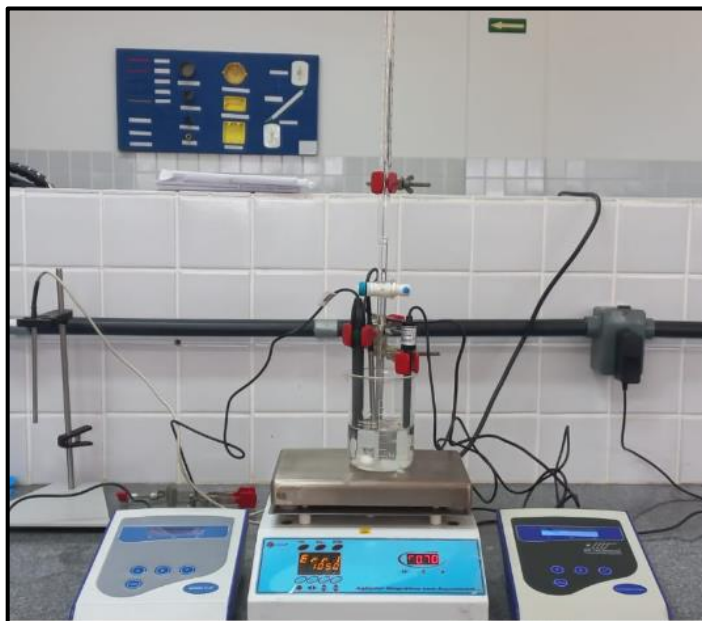
Figura 9 - Procedimento montado para realização da titulação condutimétrica.
