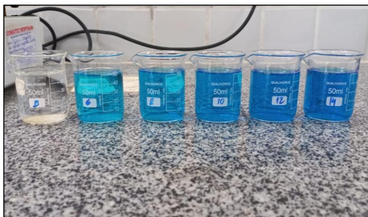
Figura 12 - Béqueres com diferentes concentrações de AM e massa fixa de quitosana.
