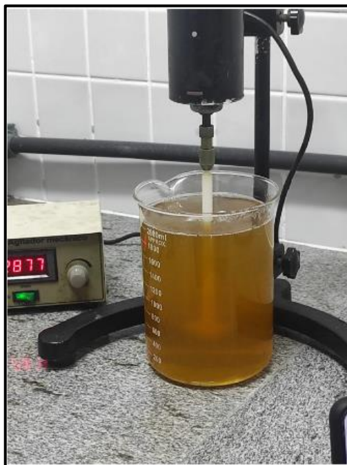
Figura 4 - Solução de ácido acético com quitosana sob agitação.
