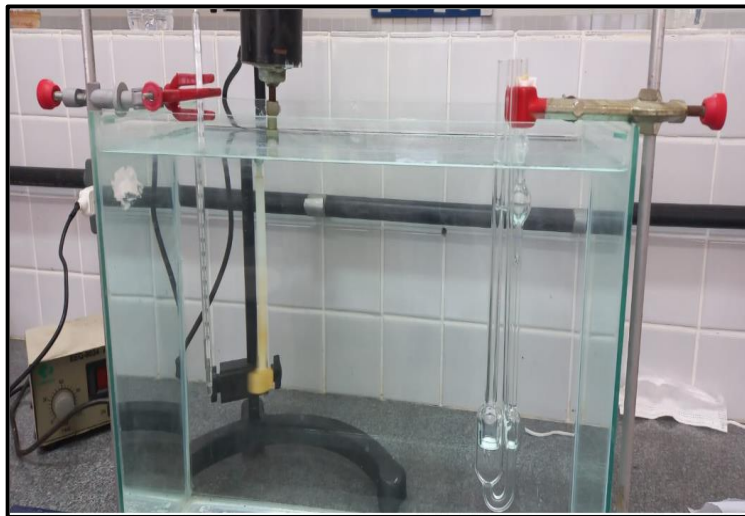
Figura 7 - Sistema montado para realização da viscosimetria capilar.
