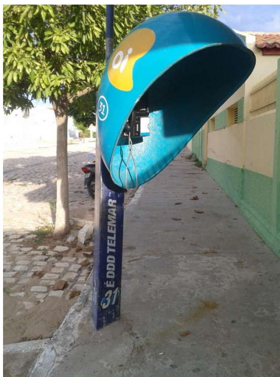
Figura 15: Orelhão sem sinalização tátil no piso.
