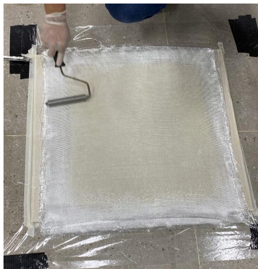
Figura 7. Processo de hand lay-up de placas de apoio.
